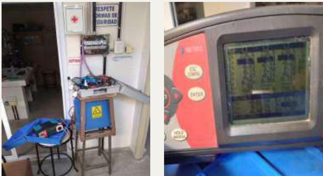
Figura 4. Dispositivo METREL para medición de consumos eléctricos en los laboratorios.
